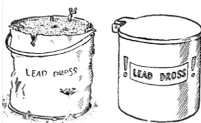
شکل ۶: پیشگیری از انتشار سرب با نگهداری ضایعات و مواد آلوده به سرب در ظروف
